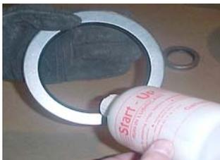
Lubricante de inicio o sacrificio que permite la colocación de retenes, sellos y empaquetaduras de una manera mas fácil con un daño a los equipos mínimo, así como el inicio del equipo con una lubricación previa.
