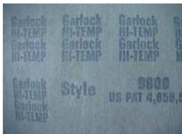
Juntas cortadas de fibras de carbón, aglomeradas bajo presión con un aglutinante elastomérico.
