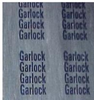
Lámina comprimida de fibra Aramídica con aglutinante de neopreno (chloroprene)
