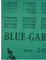
Lámina comprimida de fibras aramídicas, aglomeradas bajo presión con un aglutinante elastomérico y vulcanizado en forma de hojas homogéneas.
