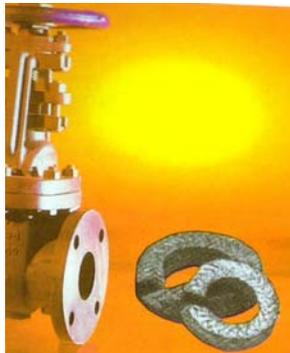
Empaquetadura trenzada cuadrada con un filamento de grafito, reforzado con alambre inonel con agente de bloqueo (inhibidor de corrosión)
