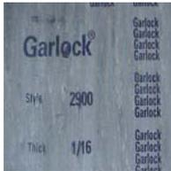
Lamina comprimida de fibras aramídicas, aglomeradas con un aglutinante elastomérico y vulcanizado en forma de hojas homogéneas.
