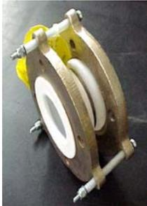
Acoplamiento flexible de PTFE tipo carrete, están diseñadas para reducir el ruido, compensar movimientos de expansión y compresión así como desalineamientos menores en tuberías. Junta diseñada de 2 pliegues.
