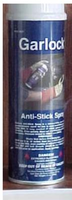
ES UN LÍQUIDO NO CONTAMINANTE QUE SE RECOMIENDA PARA LA APLICACIÓN EN SUPERFICIES DE JUNTAS Y BRIDAS PARA EVITAR QUE SE ADHIERAN ENTRE SÍ Y DIFICULTEN EL CAMBIO DE JUNTAS EN LOS TRABAJOS DE MANTENIMIENTO. TAMBIEN PUEDE USARSE EN ESPÁRRAGOS Y TUERCAS PARA APLICAR EFICIENTEMENTE EL PAR DE APRIETE A LA UNION, EVITANDO QUE CON LOS CICLOS TERMICOS LOS MATERIALES EN CONTACTO SE PEGUEN.
