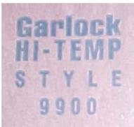
Lámina comprimida a base de fibras de grafito, aglomeradas bajo presión con un aglutinante elastomérico.
