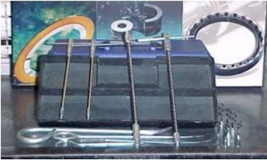
Elementos auxiliares que facilitan la instalación de la empaquetadura.
