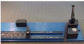
Elemento de corte que no permite la fabricación de anillos de empaquetadura evitando el problema de daño a las puntas de los anillos y mejorando la técnica de empaçado.
