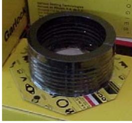
Componentes hidráulicos y neumáticos diseñados para sellar pistones, flechas y vástagos reciprocantes, su exclusivo diseño de sellado en las caras permiten el trabajo inmediato al menor cambio de presión. Además su diseño permite trabajar a cada anillo individualmente, creando un efecto automático de sellado. El diseño de múltiples anillos permite distribuir la carga a través de toda la flecha.
