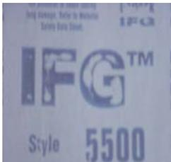
Lámina comprimida de fibra inorgánica, aglomeradas bajo presión con un aglutinante elastomérico NBR y vulcanizado en forma de hojas homogéneas.
