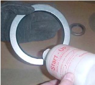
Lubricante de inicio o sacrificio que permite la colocación de retenes, sellos y empaquetaduras de una manera más fácil con un daño a los equipos mínimo, así como el inicio del equipo con una lubricación previa.
