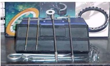
Elementos auxiliares que facilitan la instalación de la empaquetadura. Por medio de los ganchos flexibles nos permiten la extracción de la empaquetadura.
